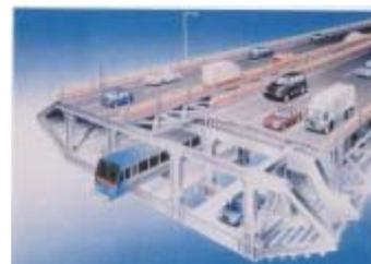
青馬大橋共有 190 個懸吊纜索，同樣用 190 個纜箍將主纜箝緊，將懸索吊纜固定在纜箍上，懸吊纜索則利用主纜的承托力將橋面吊起。每一個纜箍都用上 40 個大型的高強度螺栓將其箝緊。橋身的鋼鐵工程主要在英國、杜拜及日本等海外地區進行。製成的鋼組件則在香港以北 80 公里的珠江近東莞處組裝組件共有 50 段，每段長度為 36 米約重 1,000 公噸。當組裝完成後，這些組件便逐段由躉船運往工地，並吊至合適位置進行架設工序。整個工序需時八個月。
